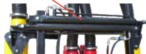
REGULAÇÃO HIDRÁULICA DA RAMPA HYDRAULIC RAMP ADJUSTMENT RÉGLAGE DE LA RAMPE HYDRAULIQUE AJUSTE DE LA RAMPA HIDRÁULICA
